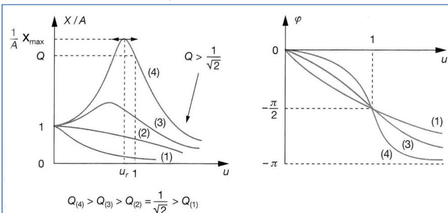
Par analogie avec le chapitre 9 sur les filtres passifs, l'oscillateur se comporte comme un filtre passe-bas d'ordre 2.
