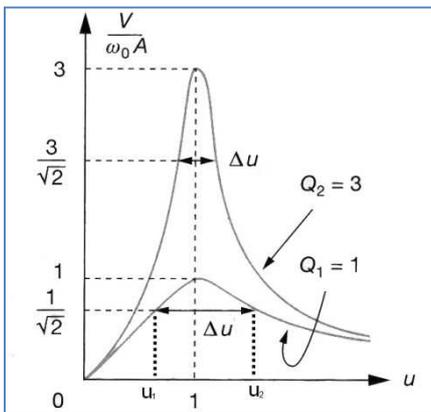
Par analogie avec le chapitre 9 sur les filtres passifs, l'oscillateur se comporte comme un filtre passe bande.
